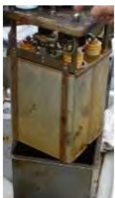
X線発生装置の低圧コンデンサーは一般に電源ユニットの蓋に取り付けられ絶縁油槽の中に漬け込まれて設置されている。
