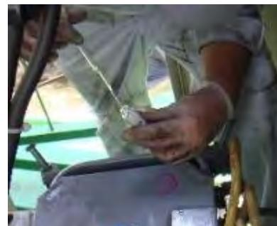
上部の蓋を外してピペットで1～2mlを採取
