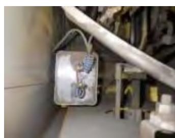
電気溶接機の内部に取り付けられた低圧コンデンサー
