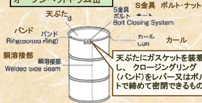
天ぶたにガスケットを装着し、クロージングリング(バンド)をレバー又はボルトで締めて密閉できるもの
