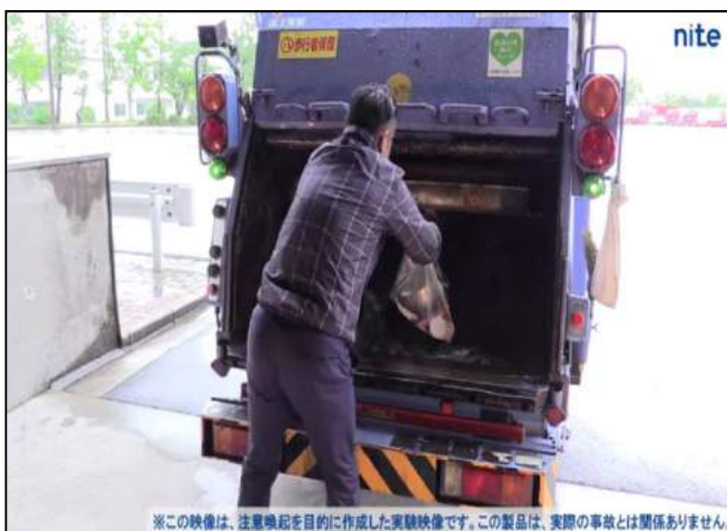
パッカー車にモバイルバッテリーが入った袋を投入
